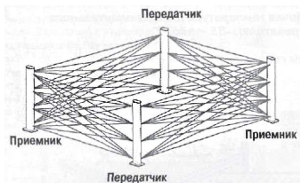
Рис. 4. Многолучевая схема работы извещателей
