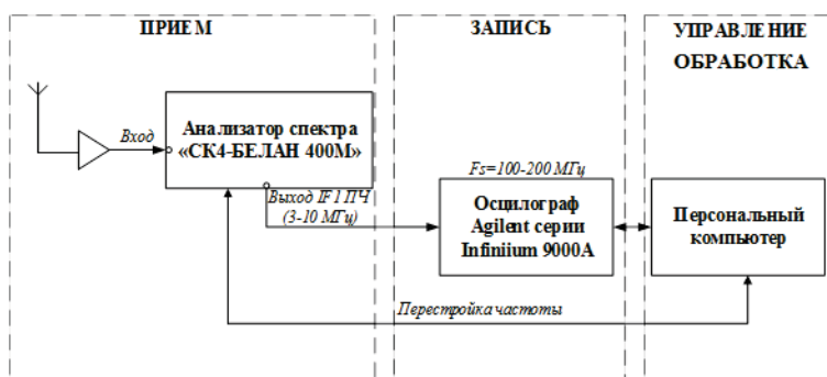
Рис. 1. Структурная схема измерительного комплекса отложенного анализа сигналов ПЭМИН
